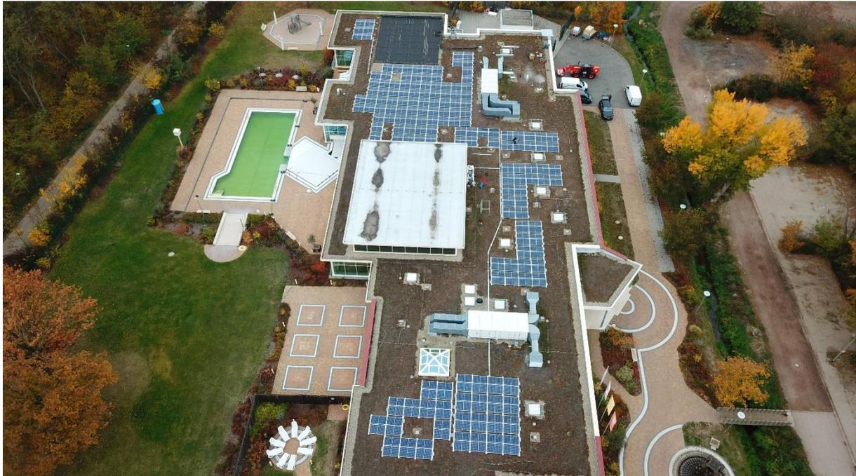
*Blick von oben: Eine besondere Herausforderung waren die vielen Aufbauten des Schwimmbades, an die die PV-Anlage angepasst werden musste. Als Balastierung der Anlage zum Schutz gegen den Wind wurde u.a. die ohnehin auf dem Dach vorhandene Kiesschüttung verwendet.*
