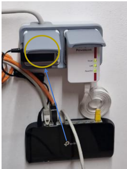
Abbildung 4 – Beispiel typischer Aufbau Switches mit Powerline
