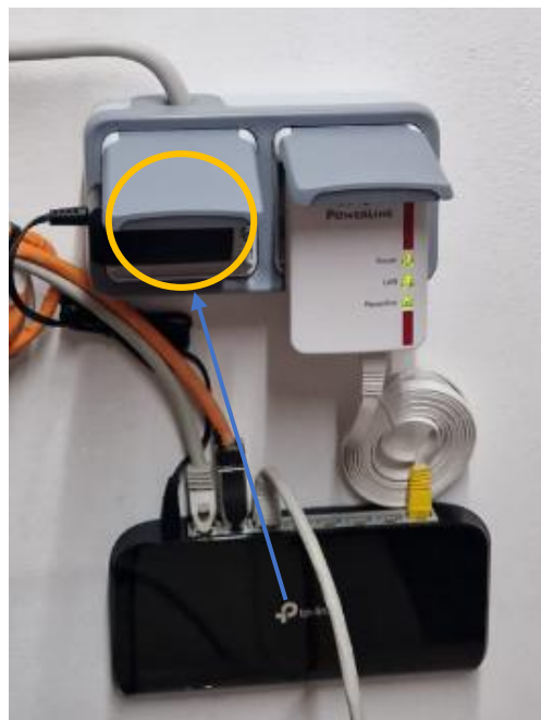
Abbildung 7 – Beispiel typischer Aufbau Switches mit Powerline
