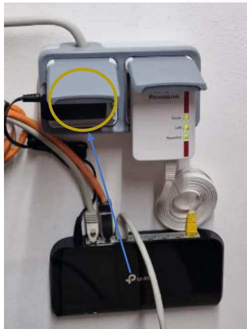
Abbildung 4 – Beispiel typischer Aufbau Switches mit Powerline
