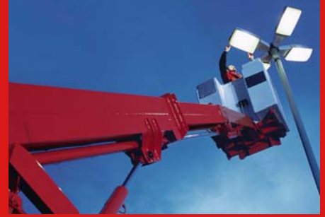
Ruthmann Steiger heißt das Gefährt, das die Mitarbeiter an ihren Arbeitsplatz in zehn Meter Höhe bringt.
